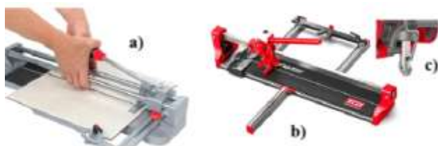
Figura 4. Tăierea plăcilor: a) desplicarea plăcilor; b) tăietor de plăci; c) dispozitiv de tăiere cu diamant.
