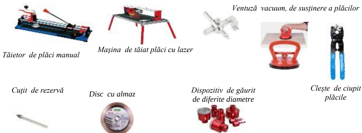
Figura 3. Instrumente și dispozitive de tăiat și găurit plăcile:
