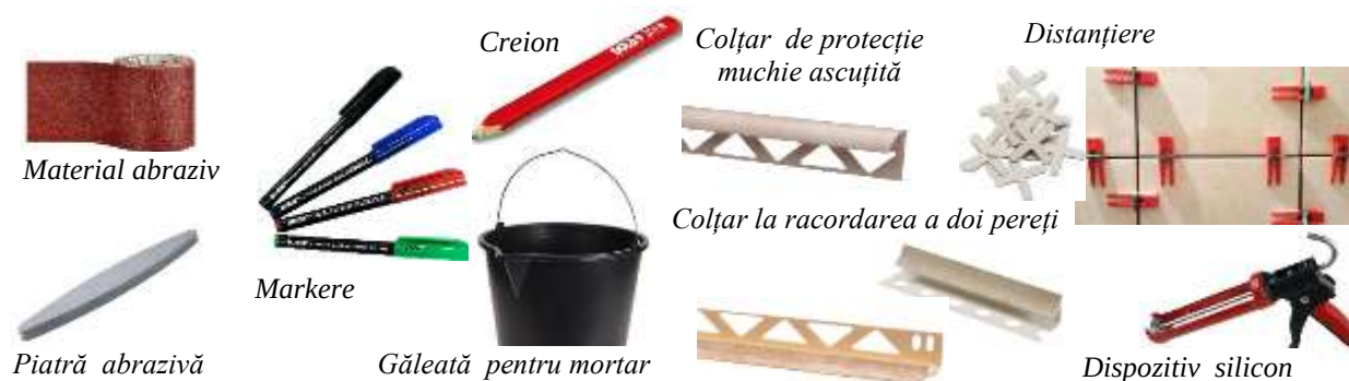
Figura 1. Materiale tehnologice și dispozitive de lucru pentru lucrări de placare:
